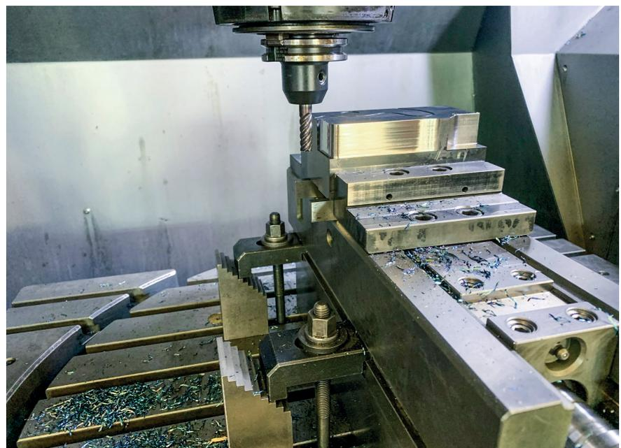
**Harter Job:** Schrappen einer Schneidmatrize aus pulvermetallurgischem HSS (65 HRC) mit dem von Mapal für das trochoide Fräsen entwickelten OptiMill-Tro-H. Geschlichtet wird danach mit dem OptiMill-3D-CR-Hardened © Mapal
